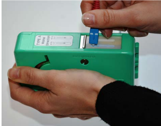
Bild Exempel på rengöring av fiberkontakt med rengöringskasett
